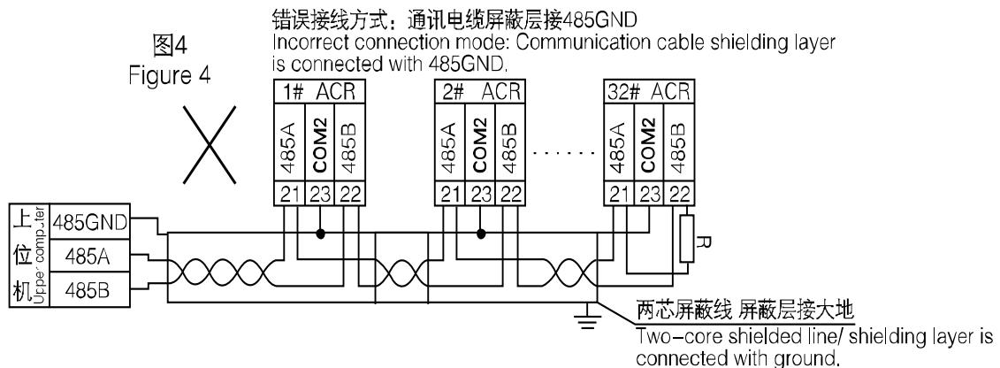
建议最末端仪表的 A、B 之间加匹配电阻，阻值范围为  $120\Omega \sim 10k\Omega$
